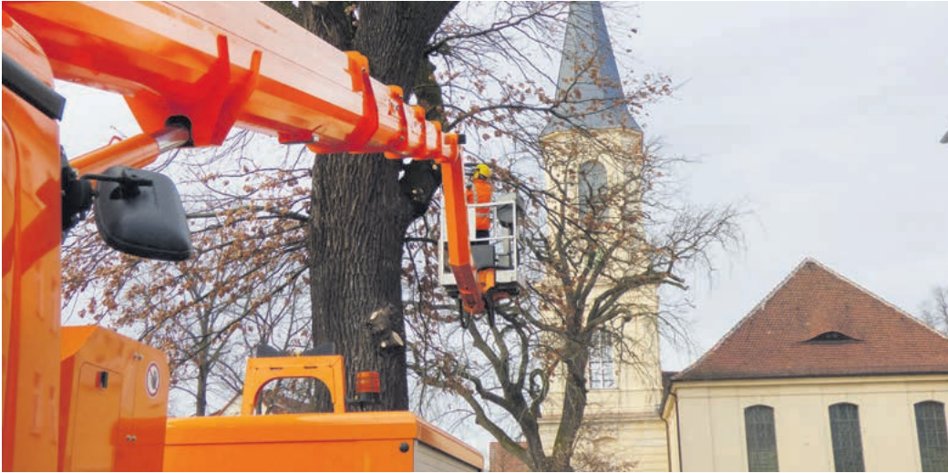
Baumschnitt in schwindelerregender Höhe - mit der Technik des Stadtbetriebes kein Problem. Der sogenannte „Hubsteiger“ kann bis zu einer Höhe von 28 m ausgefahren werden. Hier zu sehen sind Arbeiten an einer Eiche direkt vor dem Rathaus auf dem Zossener Marktplatz.
