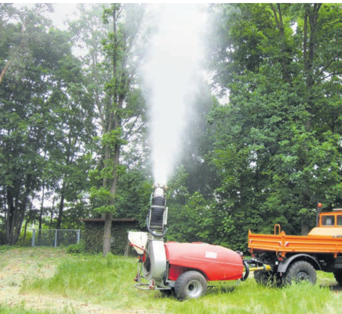
Die „Dragone“ - ein mobiles Hochdruckspritzgerät, dass zur Bekämpfung des Eichenprozessionsspinners eingesetzt wird.
