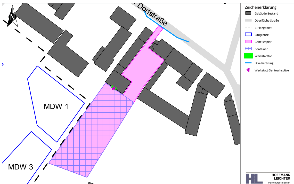
Abbildung 4-1 Übersicht der Anlagenschallquellen
